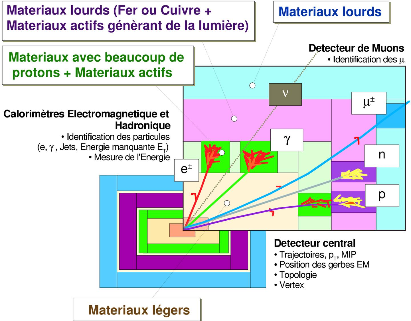
Chaque couche du détecteur permet d'identifier et de mesurer l'impulsion ou l'énergie des particules produites dans la collision
