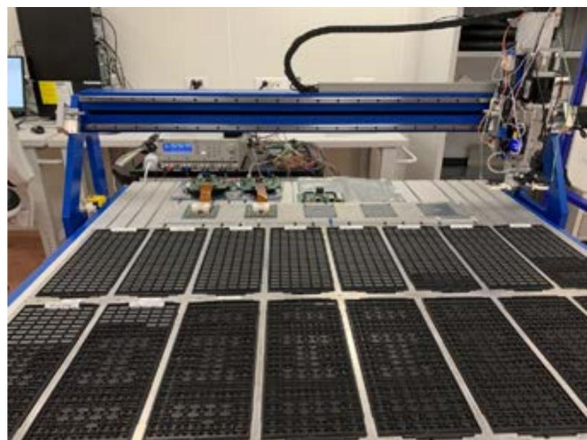
Figure 12 : Photo d'un des deux robots du LLR pour les tests de production de puces électroniques.
