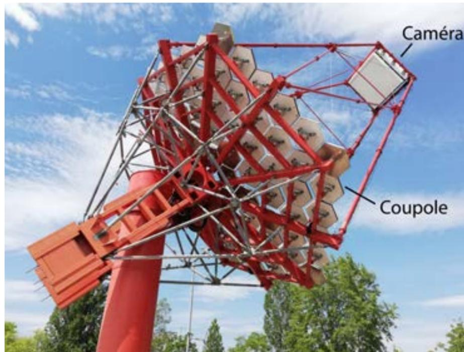
Figure 56 : Télescope de taille moyenne (MST) pour le projet Čerenkov Telescope Array (CTA) composé de miroirs de forme hexagonale créant un réflecteur uniforme d'environ 12 mètres de diamètre. La surface réfléchissante de 88 m<sup>2</sup> recueille et concentre la lumière Čerenkov dans la caméra, où la lumière peut être numérisée et traitée. Le site nord de CTA fonctionnera avec les caméras NectarCAM à grand champ de vision (environ 8°) et utilisant des photomultiplicateurs.
