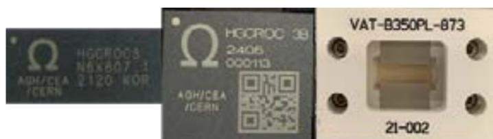
Figure 11 : À gauche : Puce HGCROC HD de taille 17.0 × 8.0mm. Au centre : Puce HGCROC LD de taille 20.0 x 16.8 mm<sup>2</sup>. À droite : "Socket" servant à connecter les puces HD au banc de test.
