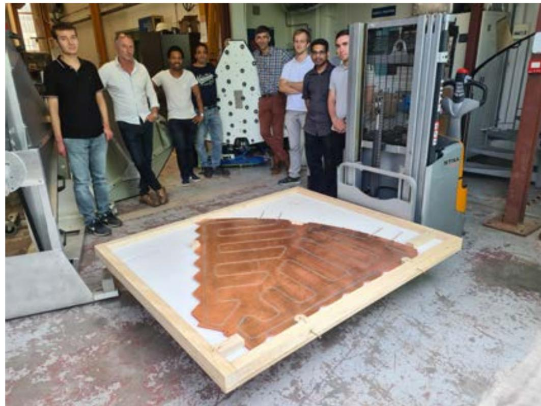
Figure 8 : Prototype de plaque de refroidissement en cuivre de HGCAL réalisée au sein du LLR, avant sa livraison au CERN.
