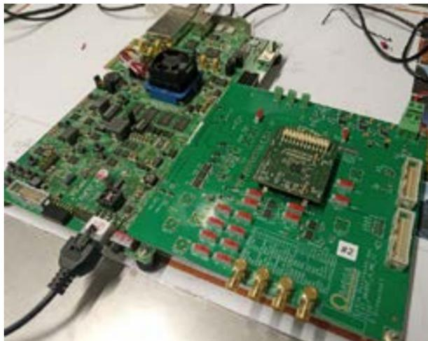
Figure 39 : Carte de test (appelée version 0) de l'ASIC HKROC.
