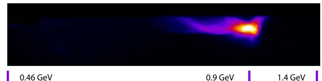
Figure 67 : Spectre énergétique d'électrons (données brutes) observé lors d'un tir APOLLON à 0.5PW sur cible. L'échelle de couleur reflète la densité de charge sur l'écran. L'axe horizontal est l'énergie, l'axe vertical est corrélé à l'angle vertical.
