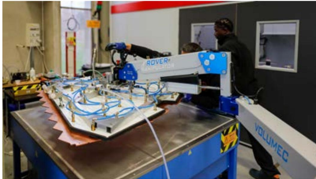
Figure 9 : Palonnier avec plaque de cuivre pour la mise en position sur la table chauffante.
