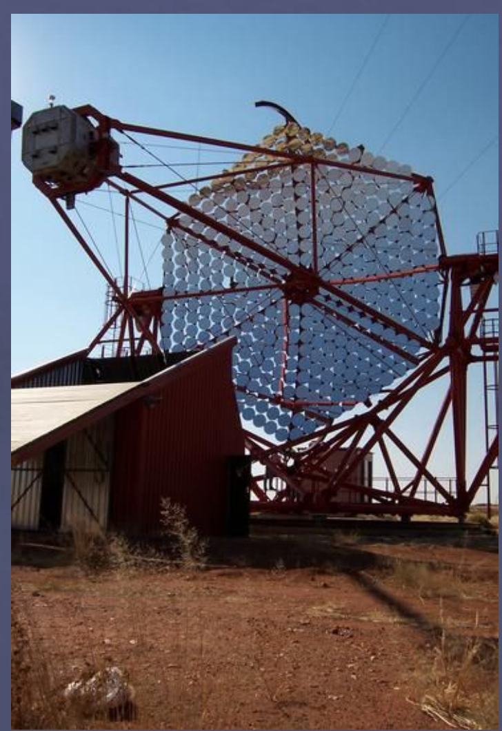
Le miroir de 12m de diamètre focalise la lumière sur la caméra du détecteur.
