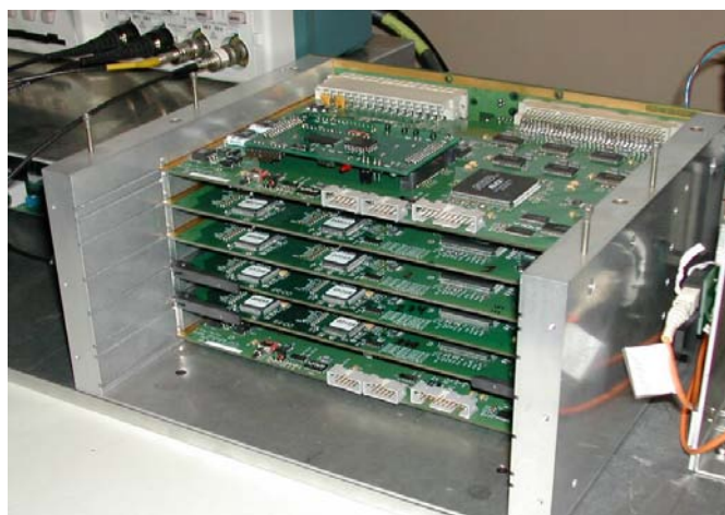
Figure 4 : un panier contenant 4 cartes CROC, 2 cartes contrôleur, 2 cartes ARCNET et une carte de fond de panier
