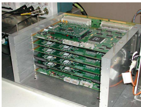
FIG. II.16 – Photographie d'un châssis d'électronique de lecture du trajectographe. Les deux cartes contrôleuses sont situées au dessus et en dessous des cartes de lectures. Deux cartes CROCs sont reliées à chaque carte CNTL.
