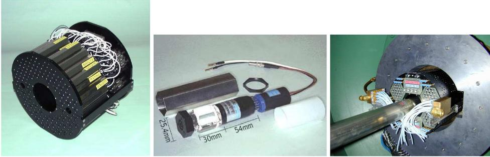
(a) Un BBC. Dimensions du cylindre : 29 cm de rayon, 25 cm de longueur. (b) Un élément constitutif du BBC (quartz hexagonal à effet Čerenkov terminé par un photomultiplicateur). (c) Installation du BBC autour du faisceau et près de l'aimant central (au dernier plan, en vert).
