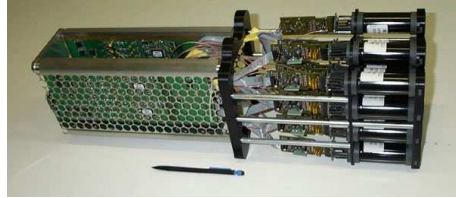
Figure 7.10: Photographie d'un tiroir de la caméra de HESS ; le stylo présent au premier plan donne une idée de l'échelle.
