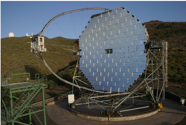
Figure 4.10: Photographie du télescope de 17 m de diamètre MAGIC.
