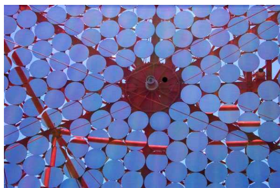
F . 4.4 – À gauche : Vue des miroirs de H.E.S.S., chaque télescope est doté d'une surface réfléchissante constituée de 380 miroirs de 60 cm de diamètre pour une surface totale de 107 m 2 . À droite : Schéma des supports motorisés d'un miroir permettant son alignement.
