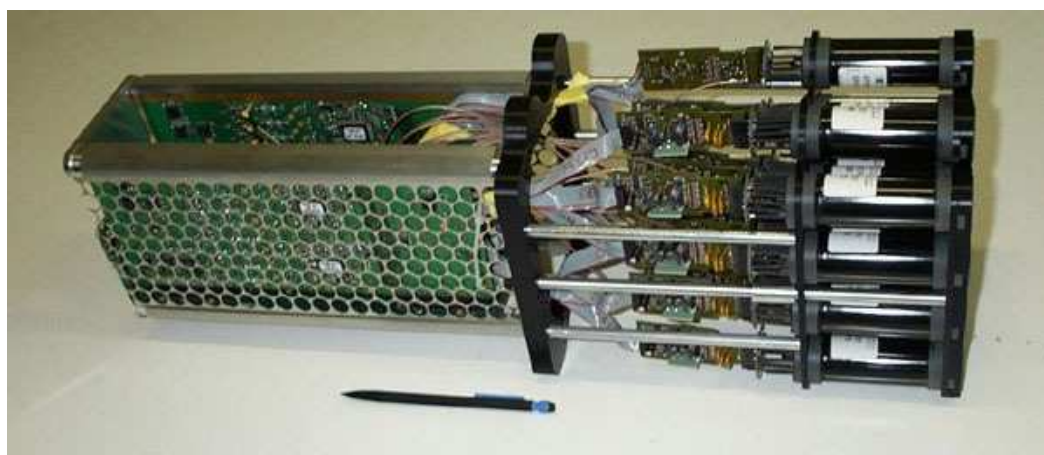
Fig. 4.10 – Photographie d'un tiroir des caméras de H.E.S.S. Les tubes photomultiplicateurs sont situés à droite ; chaque tiroir en comporte 16. Ils sont reliés par leurs bases (au milieu) aux cartes électroniques (à gauche). Chaque tiroir contient deux cartes analogiques (une pour huit PMs) et une carte de slow-control.
